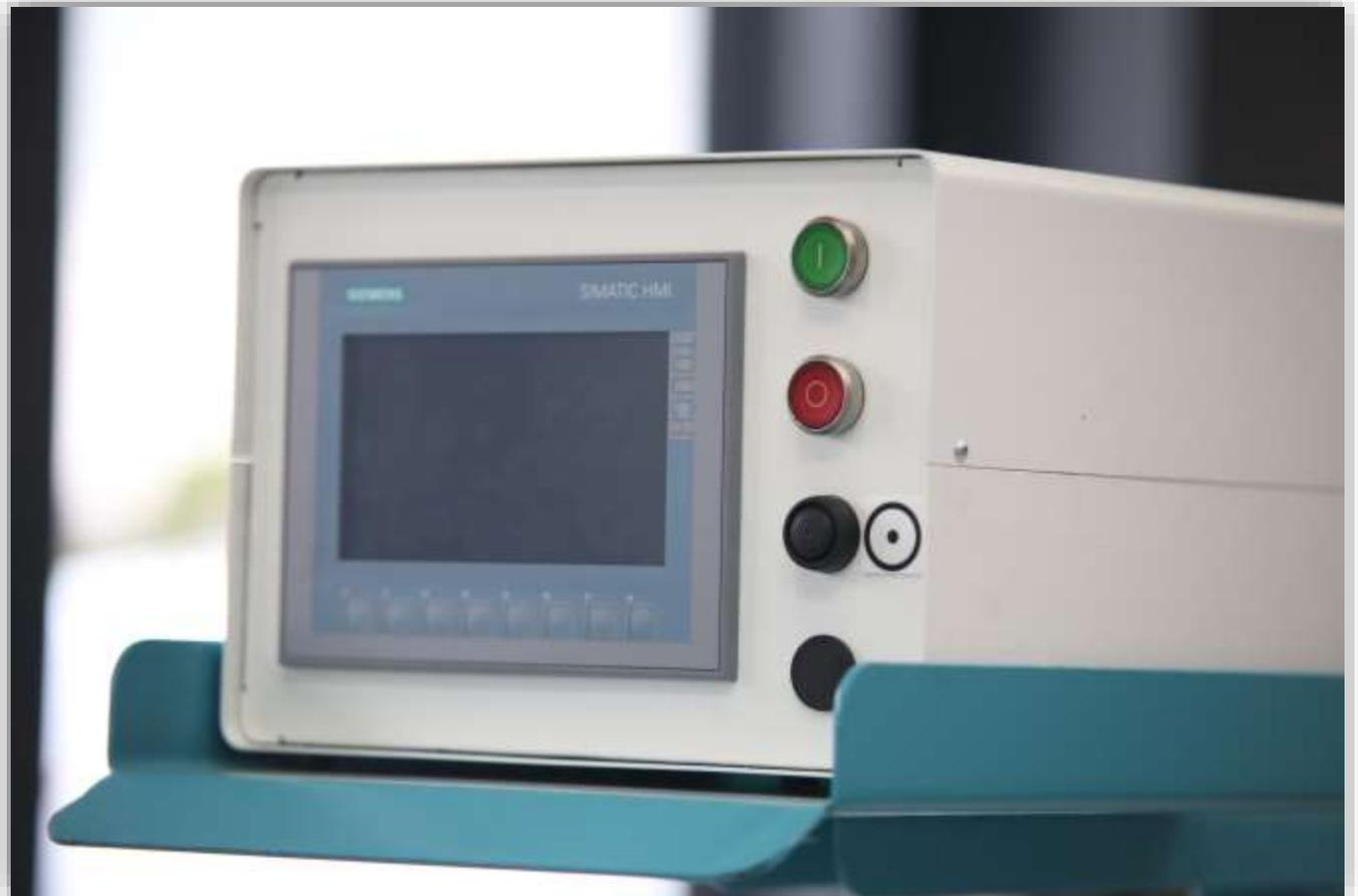
Neue Steuerung für Längenanschlag L50 NC
